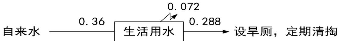
图 3-4 本项目采暖季水平衡图 (m<sup>3</sup>/d)
